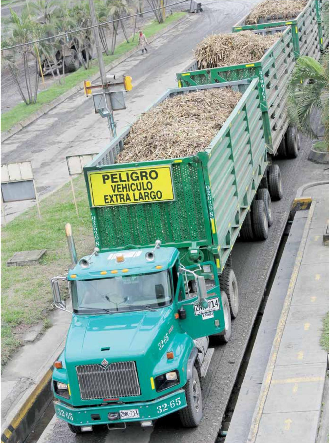
Tren cañero con vagones de descarga lateral diseñados por Cenicaña
